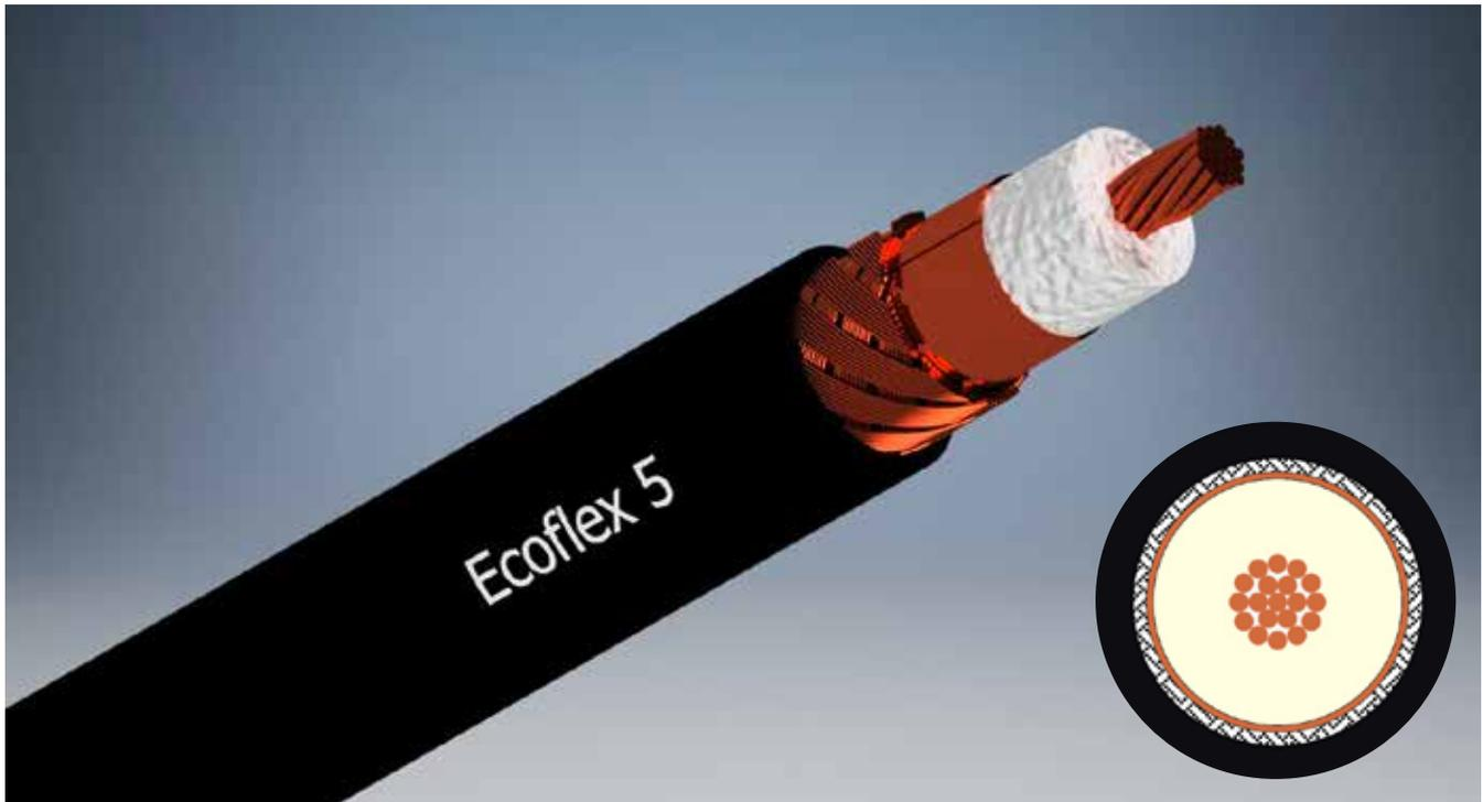
Ecoflex 5 ist ein dünnes und hochflexibles Koaxialkabel für den Frequenzbereich bis 6 GHz. Die niedrige Dämpfung und der extrem kleine Biegeradius dieses Kabels bei einem Durchmesser von 5,5 mm machen den Einsatz für viele Anwendungen in der Hochfrequenztechnik interessant und empfehlenswert.
