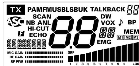
Das Hauptbalkendiagramm zeigt den Empfangspegel und die Ausgabe der Sendeleistung. Die kleinere Balkenanzeige zeigt Mikrofonverstärkung, RF-Verstärkung und eingestellte Sendeleistung.
