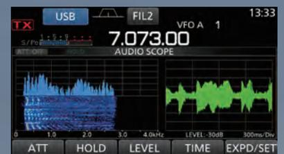
FFT-Spektrum und Oszillogramm
