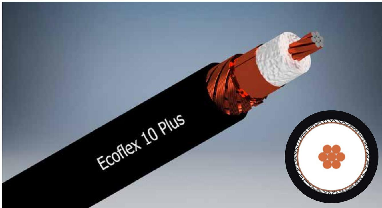
Ecoflex 10 Plus ist ein hochflexibles, verlustarmes Koaxialkabel, das speziell für den Einsatz bis zu 8 GHz entwickelt wurde. Modernste Produktionsverfahren und die Verwendung eines verlustarmen PE-LLC-Dielektrikums mit einem Gasanteil von über 70% ermöglichen sehr geringe Dämpfungswerte. Das Ecoflex 10 Plus setzt bei flexiblen Koaxialkabeln neue Maßstäbe.
