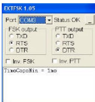
Stellen Sie EXTFSK auf den verwendeten Port und wählen Sie die Einstellungen für die PTT- und FSK-Steuerung. RTS ist für PTT und DTR für FSK voreingestellt.
