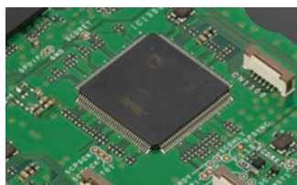
DSP für das Bandspk ADSP-21363, Takt 332 MHz
