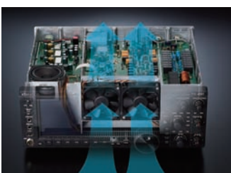
Die beiden Ventilatoren liegen hinter der Frontplatte
