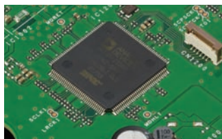
ZF-DSP des Senders ADSP-21363, Takt 332 MHz
